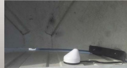
DSRC Rádio Antena (Caminhão)
