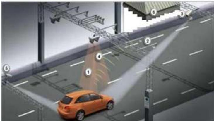
Os sistemas de ETC têm duas partes principais. Além da parte visível, envolvendo o transmissor ou o identificador no interior ou no exterior dos veículos e no sistema de leitura na estrada, há uma quantidade considerável de equipamentos, tecnologias e recursos atuando na parte administrativa.
