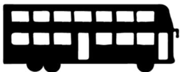
**Autobús de dos pisos:** Un autobús de dos pisos tiene dos secciones, una encima de la otra, que proporcionan capacidad de asientos. Estos autobuses suelen tener tres ejes y su longitud varía comúnmente de 9.1 a 13.7 metros y pueden transportar hasta 120 pasajeros.
